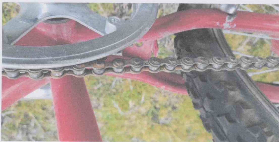
CADENA OXIDADA Y DURA.
